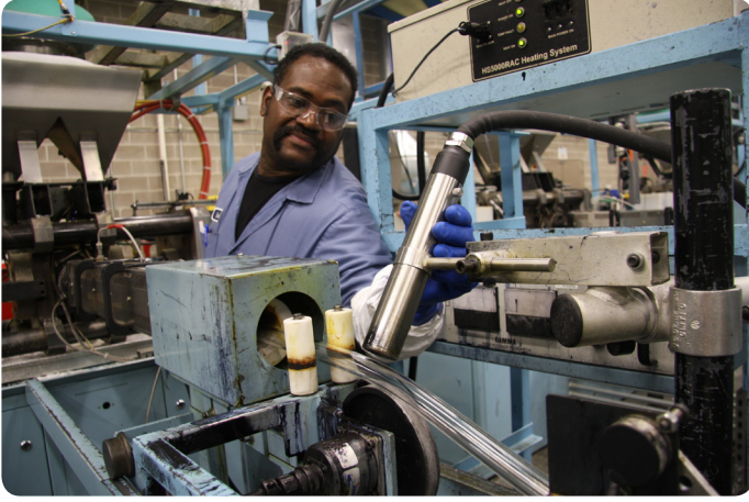
Uponor operatörü Mark Morgan Videojet 1620 sürekli mürekkep püskürtmeli yazıcıda bulunan yazdırma kafasını ayarlıyor
